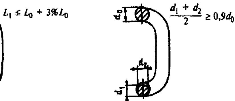
Рисунок 19. Уменьшение диаметра сечения звена цепи:
