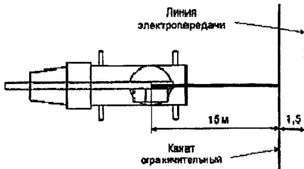
Ограничитель или указатель опасного приближения к ЛЭП считается работоспособным, если срабатывание происходит при выдвижении или наклоне стрелы крана до соприкосновения ее головки с ограничительным канатом.
