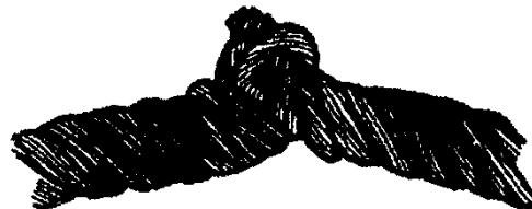
Рисунок 15. Перекручивание каната.
