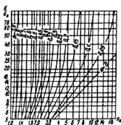
Рис.2. Номограмма для определения начального разбавления в потоке
